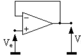
Fig. 10. Amplificateur suiveur.
