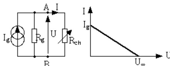
Fig. 16. Droite de charge d'un générateur de courant.
