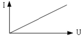
Fig. 9. Caractéristique de résistance.
