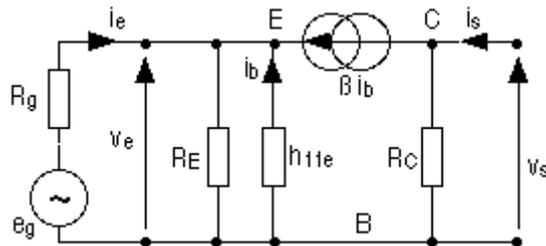
Fig. 21. Schéma équivalent base commune.
