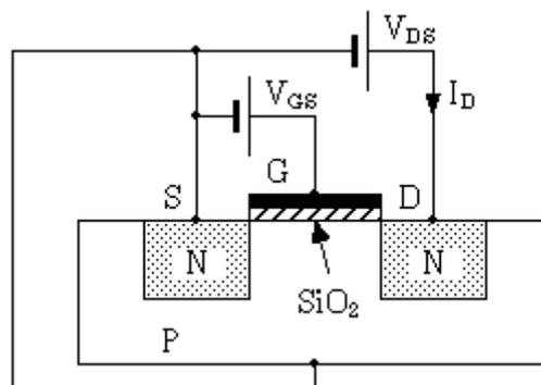
Fig. 12. Schéma de principe d'un MOSFET canal N.
