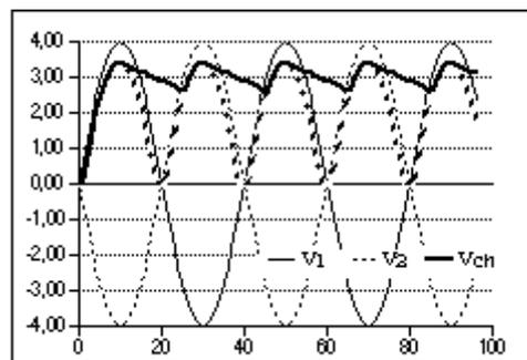
Fig. 17. Redressement double alternance et filtrage.
