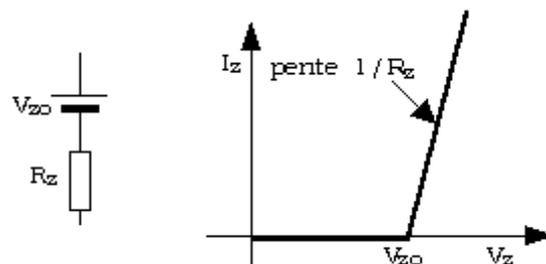
Fig. 26. Schéma équivalent de la diode zéner
