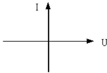
Fig. 26. Caractéristique d'un interrupteur fermé.
