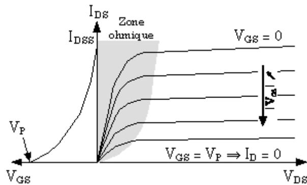
Fig. 5. Caractéristiques du FET à jonction.
