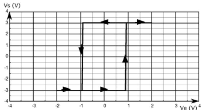
Fig. 23. Cycle d'hystérésis du trigger
