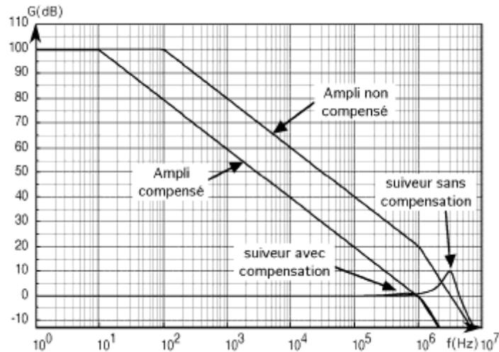
Fig. 37. Compensation d'un ampli à gain unité.
