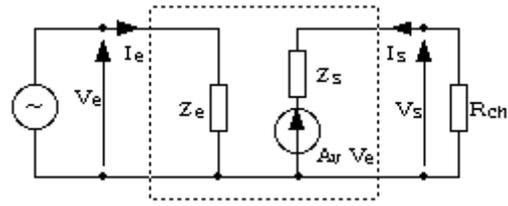
Fig. 16. Schéma équivalent de l'étage amplificateur.
