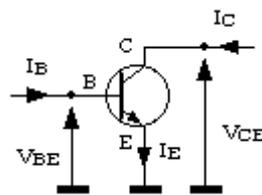
Fig. 3. Courants et tensions sur un NPN.
