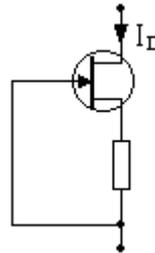
Fig. 11. Source de courant à deux bornes.
