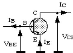
Fig. 4. Courants et tensions sur un PNP.
