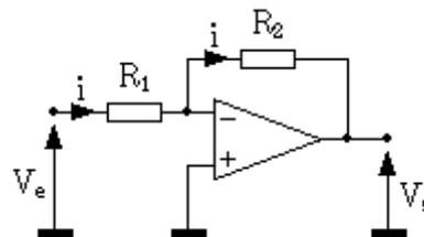
Fig. 5. Amplificateur inverseur.
