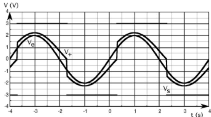
Fig. 22. Signaux sur le trigger
