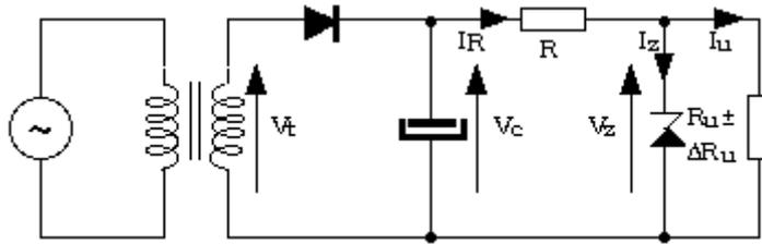
Fig. 27. Régulation de tension avec diode zéner.
