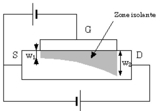
Fig. 4. Modulation de conductivité pour  $V_{DS}$  non nul.
