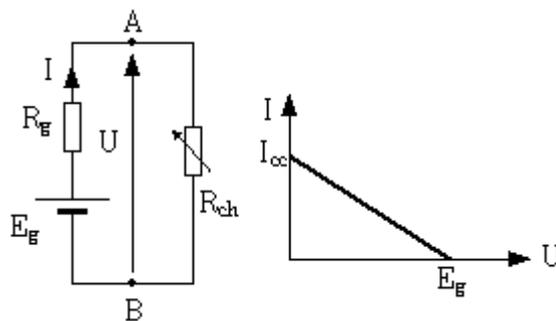
Fig. 15. Droite de charge d'un générateur de tension.
