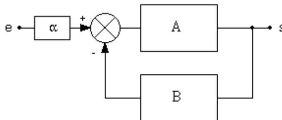
Fig. 3. Système bouclé.
