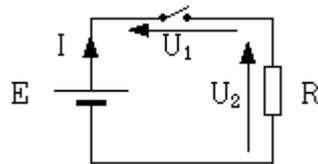
Fig. 23. Interrupteur ouvert dans une boucle.
