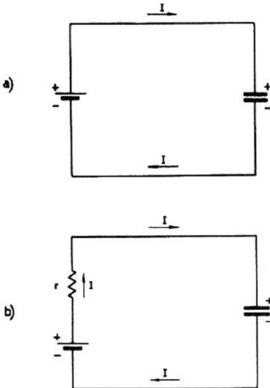
CIRCUIT DE CHARGE D'UN CONDENSATEUR
